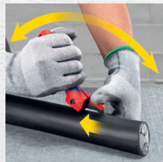
Funkce ráčny umožňuje odizolování s větším pohodlím a menší námahou
