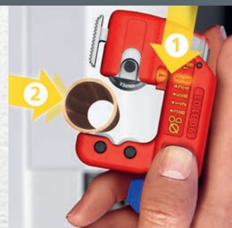
... předem nastavte na stupnici a zacvakněte na trubku pomocí odpruženého řezacího kolečka
